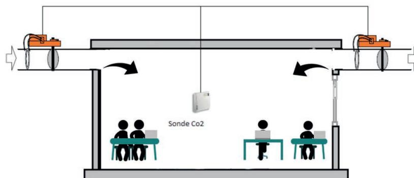
Si le débit ou la pression du ventilateur change en amont du régulateur (alimentation d'un second local par le même ventilateur par exemple), le servomoteur adaptera l'ouverture de la lame afin de respecter la consigne.
