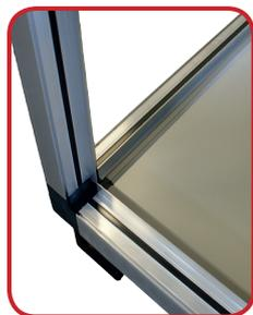
Le caisson est basé sur sur une **structure** profilée aluminium 55 mm à **rupture de pont thermique** (Classe TB1) associé à des parois double peau isolées par 45 mm de mousse de polyuréthane condensée (Classe T1). La face extérieure reçoit une finition laquée blanc RAL 9002 tandis que l'intérieure reste en acier galvanisé. Le principe d'assemblage de la structure permet une grande rigidité de l'enveloppe et lui procure une classe de déformation exceptionnelle (Classement D1).
